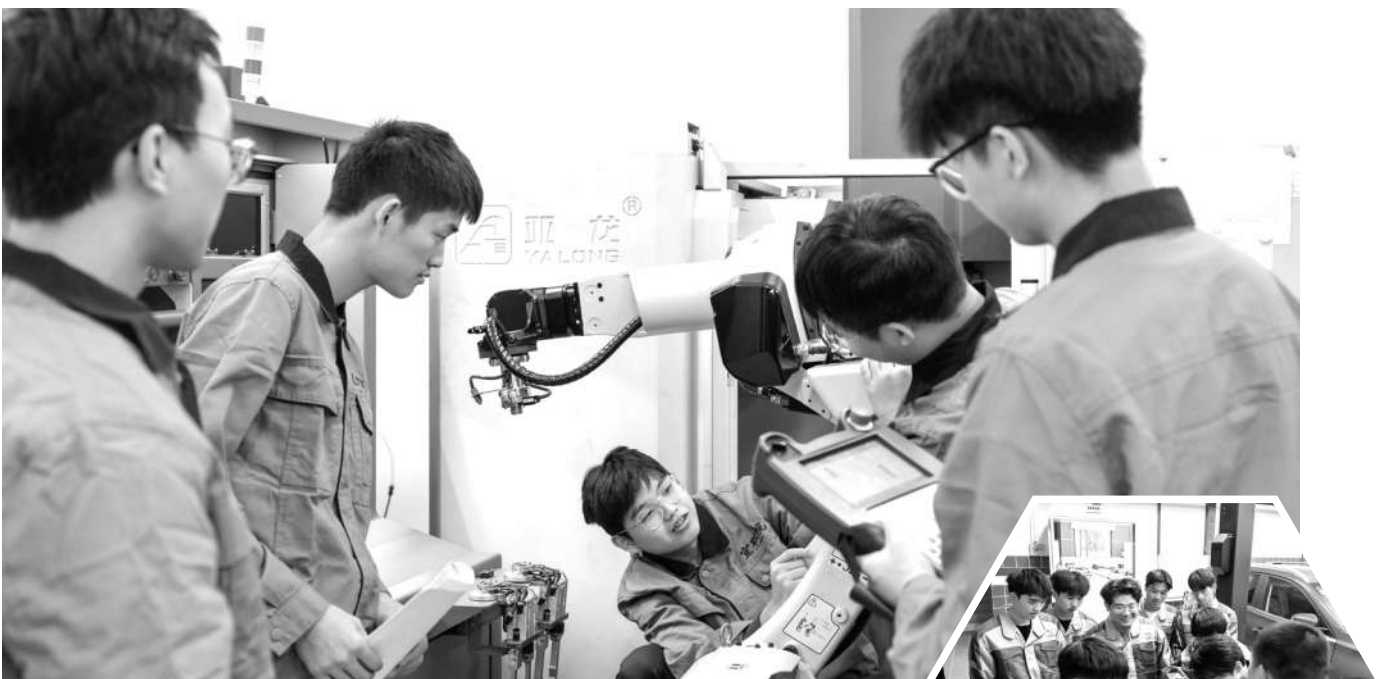
▲宜宾职业技术学院数控专业学生在调试工业机器人协助数控机床自动上下料。 ▶宜宾职业技术学院汽车与轨道交通学院学生在企业车间实训。 资料图片
