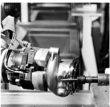
工业机器人通过机械臂抓取产品自动化去毛刺。 李尧 摄
