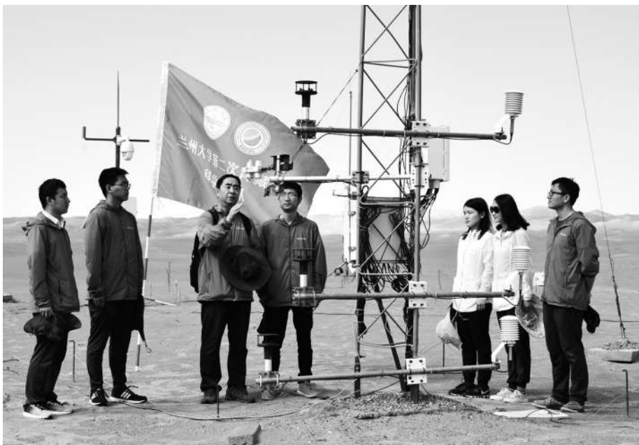
2019年，兰州大学第二次青藏科考过程中，黄建平院士（左三）在塔中沙漠野外气象观测站为队员讲解闭路涡动相关通量观测系统。（资料图片）
