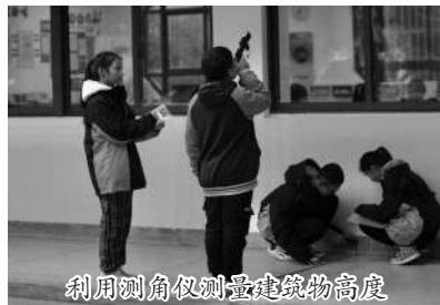
利用测角仪测量建筑物高度
