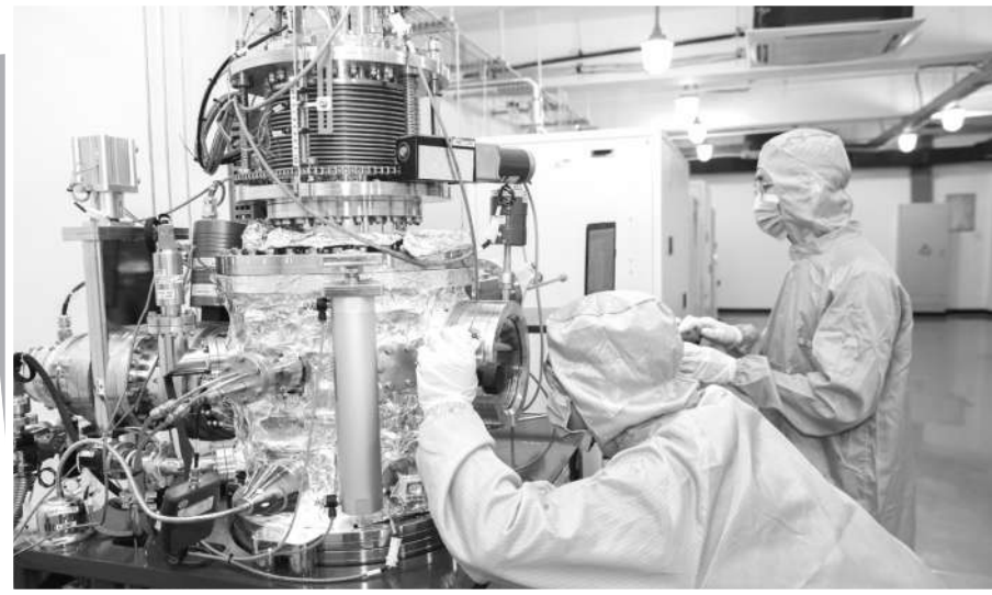
集美大学半导体产业技术研究院（厦门市超宽禁带半导体材料与器件重点实验室）研究人员在进行氮化铝薄膜材料制备实验。
