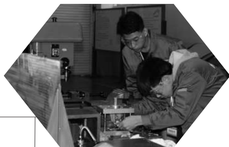
▲参加全国职业院校技能大赛的学生在模具车间装配冲压机具
