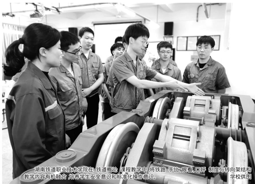
湖南铁道职业技术学院在“铁道概论”课程教学中,将铁路“手比、眼看、口呼”制度与转向架结构教学内容有机融合,培养学生安全意识和标准化操作意识。学校供图
