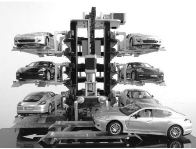
2018年获全国大学生机械创新设计大赛一等奖作品——双幅盘式抗风立体停车库
