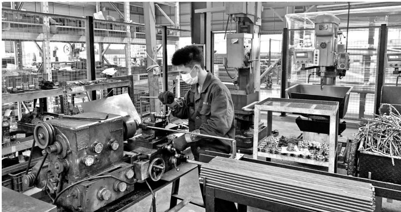
▲浙江信息工程学校学生余世长在浙江中轴物流设备有限公司车间进行轴类零件加工。
