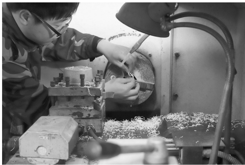
车完零件清理切屑。何雨瞳 摄
